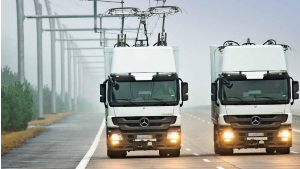
Abb. 2: Daimler-Lkw auf der Oberleitungsteststrecke in Schweden, Foto: Daimler AG)
